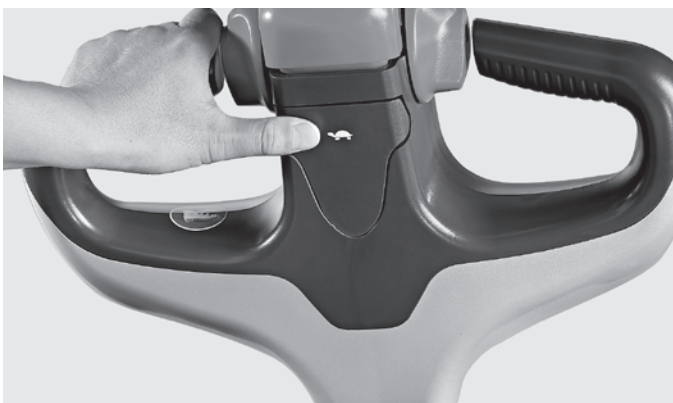
При помощи функции замедления хода легко перемещаться в условиях ограниченного пространства
