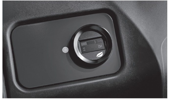
Дисплей информирует оператора о состоянии заряда и моточасах
