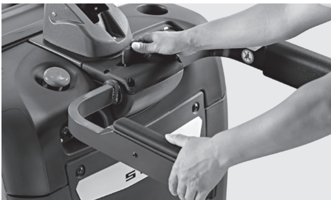
Оptionальные боковые защитные поручни можно быстро и легко опустить для обеспечения безопасности и устойчивости оператора
