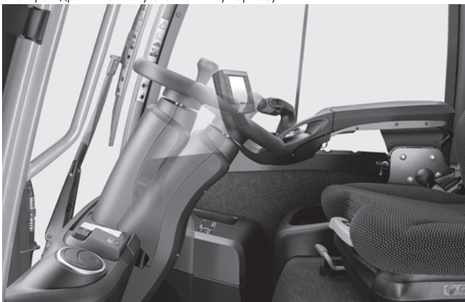
Возможность индивидуальной регулировки рулевой колонки
