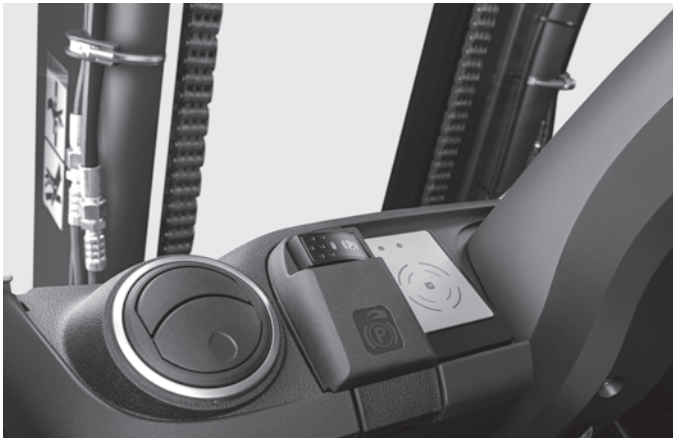
Превосходная устойчивость в любой ситуации благодаря электрогидравлическому стояночному тормозу
